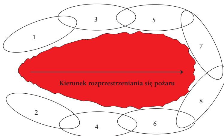
Rycina 9. Kolejność wykonywania zrzutów podczas gaszenia pożarów o dużej intensywności
